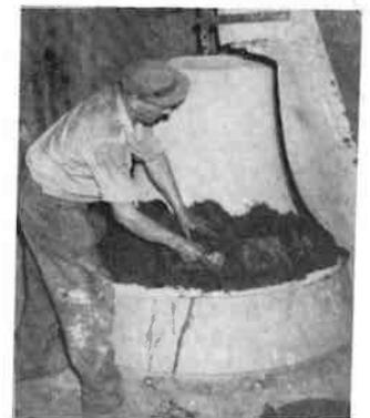
Auf diesen Kern wird nun die "Falsche Glocke" aus Lehm aufgetragen. Darauf werden Innschrift und Verzierung aus Wachs aufgeklebt.
