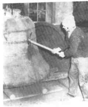
Nach einer Woche: Die Glocke wird ausgegraben. Mantel und Kern werden entfernt.
