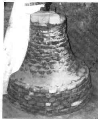
Nach der Berechnung von Ton, Schwingungszahl und Durchmesser wird mit Hilfe einer Schablone der Glockenkern aus Ziegeln aufgemauert und mit Lehm bestrichen.
